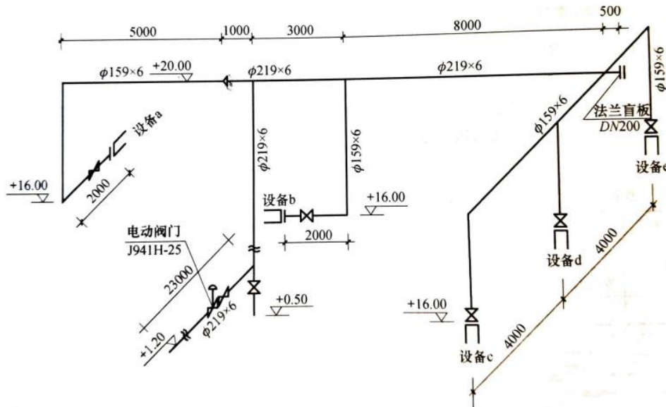
图 1 部分热交换工艺管道系统施工图
