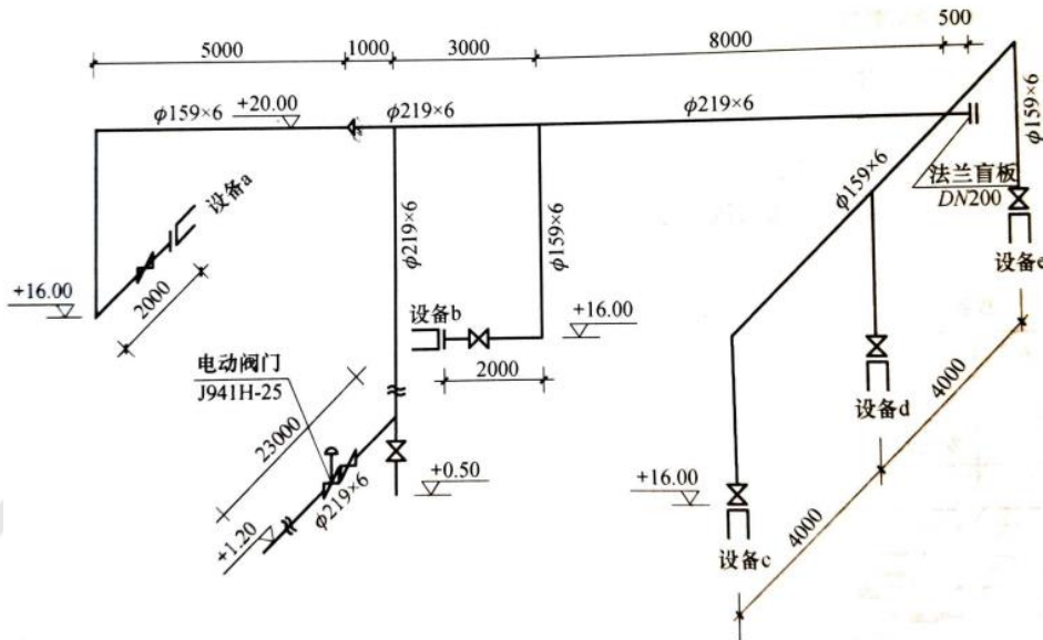
图 1 部分热交换工艺管道系统施工图
