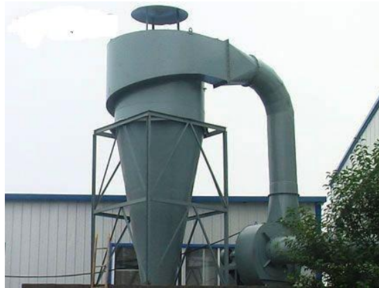
1-进气管, 2-圆筒体, 3-排气管, 4-导向叶片, 5-倒圆锥, 6-下锥体, 7 排灰口
