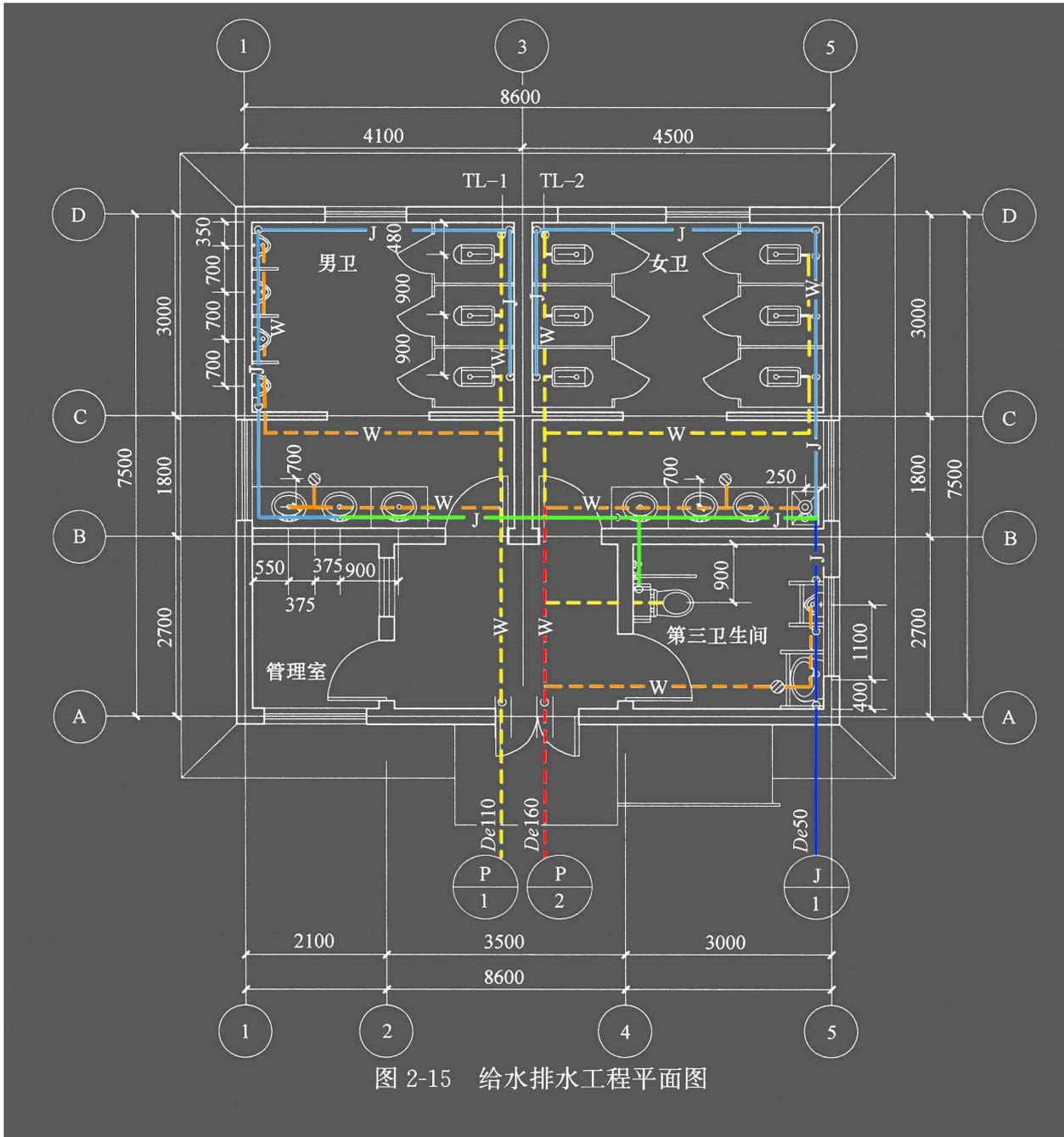
图 2-15 给水排水工程平面图
